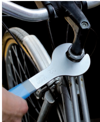
Zur Einstellung eines Gewindesteuersatzes ist wegen der benötigten Werkzeuge meist nur eine Fachwerkstatt in der Lage.
