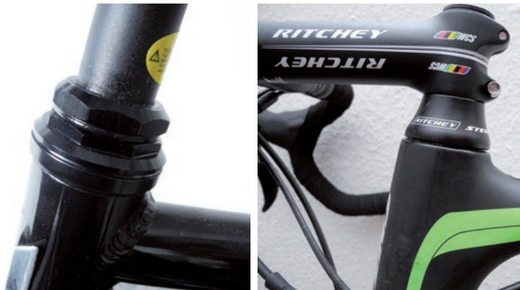
links Klassischer Gewindesteuersatz mit außenliegender Lagerschale. rechts Integrierter Ahead-Steuersatz.
